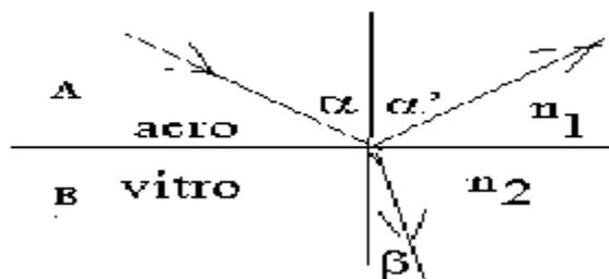
$\alpha$ : trafangulo,  $\alpha'$ : reflektangulo,  $\beta$  refraktangulo,  $v_1$ : rapido en medio A,  $v_2$ : rapido en medio B.
